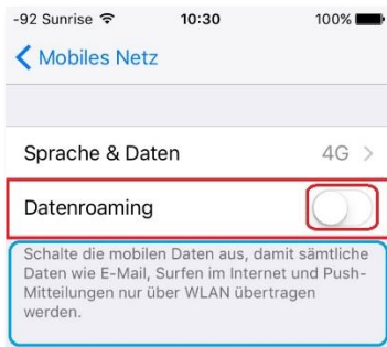
4. Bei Datenroaming Hebel nach rechts stossen.
