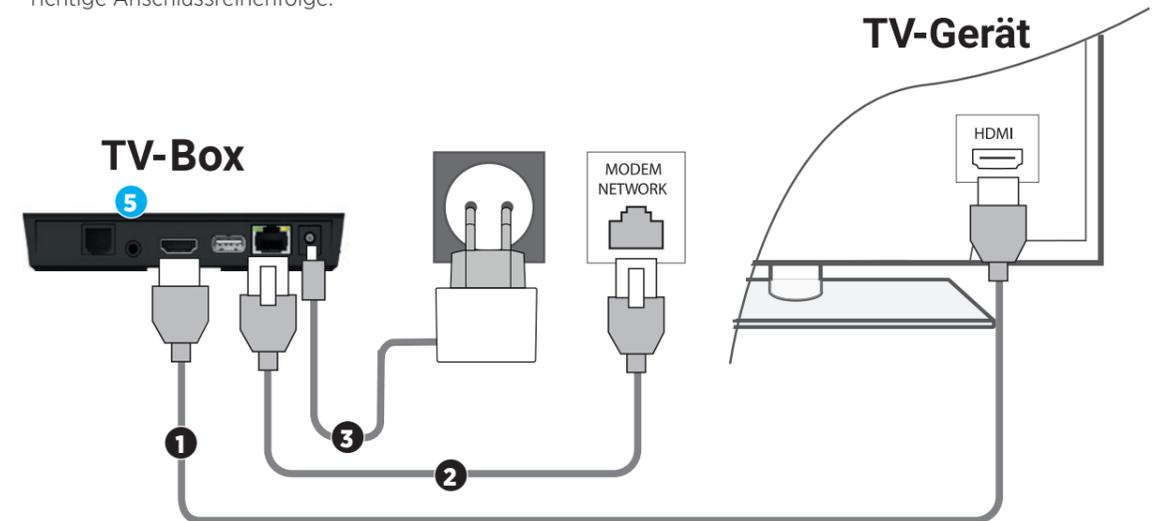
1 HDMI Kabel 2 Netzwerkkabel 3 Stecker Netzteil
