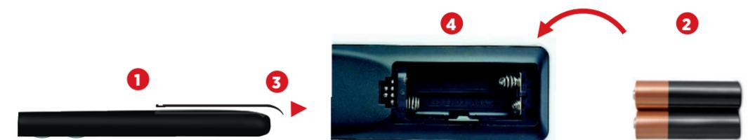
Ziehen Sie den Schnappverschluss 1 nach hinten, um das Batteriefach zu öffnen.
